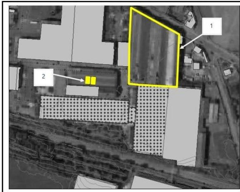
1 : Les murs des bâtiments M et C sont finalement conservés, offrant une protection à la ZER 2. La toiture est enlevée.
